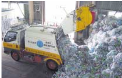
大宮リサイクルセンターでは空き缶・ビン・ペットボトルを分別して、圧縮処理をしています
