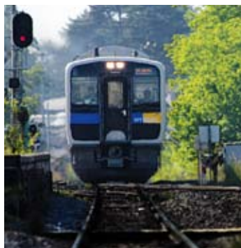
小海線を走る世界初のディーゼルハイブリッド鉄道車両
