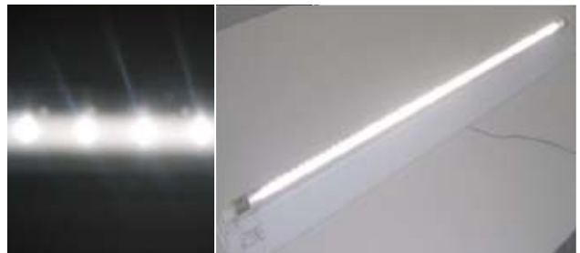
LED照明(BT-OWL) 開発中/ 省電力(蛍光灯の約1/2)、長寿命(蛍光灯の約7倍)、無公害(水銀レス)
