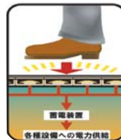
発電床の仕組み
