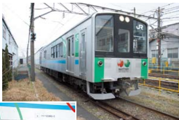
燃料電池ハイブリッド鉄道車両の走行試験を開始
