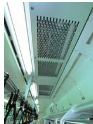
通勤型車両初の空気清浄機の設置
