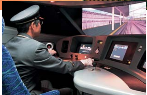
実車感覚で事故予防訓練を行う「新幹線運転士訓練用シミュレータ」
