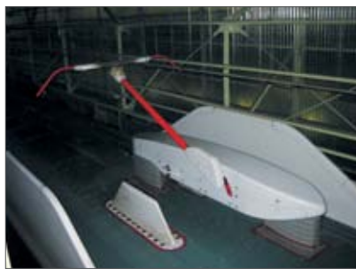
試験車両「FASTECH 360」では、低騒音型の一本主柱型パンタグラフを搭載
