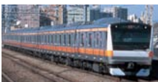
主要な機器を二重系化し、故障に強い車両となった「E233系」
