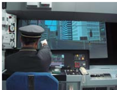
リアルな実車感覚で事故予防型訓練を行う「運転士訓練用シミュレータ」
