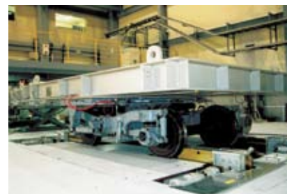
JR東日本研究開発センターの試験設備 (台車試験装置)
