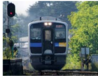
小海線を走る世界初のディーゼルハイブリッド鉄道車両
