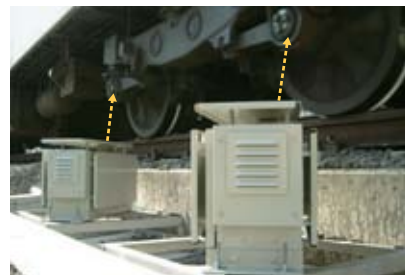
車軸軸箱温度検知装置（矢印の先が車軸軸箱）
