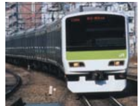
E231系 通勤・近郊での主力として活躍するVVVFインバータ車両
