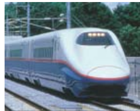
E2系 新幹線「あさま」や「はやて」などで採用されているVVVFインバータ車両
