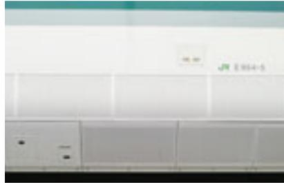
試験車両FASTECH360では、車体の下部や底面に吸音材を取り付けて騒音を吸収する構造を採用
