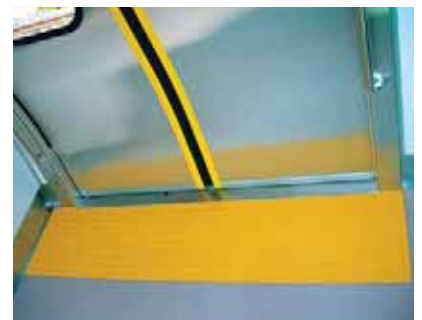
常磐線新型車両E531系には、ドア周りの認識しやすい配色や電動車いす対応型トイレも設置
