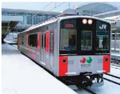
さらなる性能向上をめざし、蓄電池を改良し冬季走行試験を行ったNETレイン
