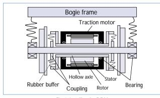
Fig. 4 Installing the DDM
