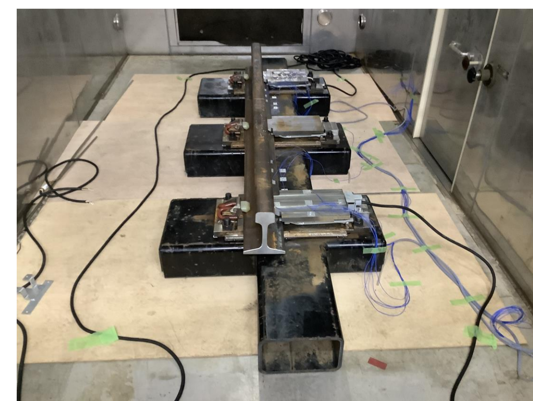
温度上昇試験(電気融雪器)
