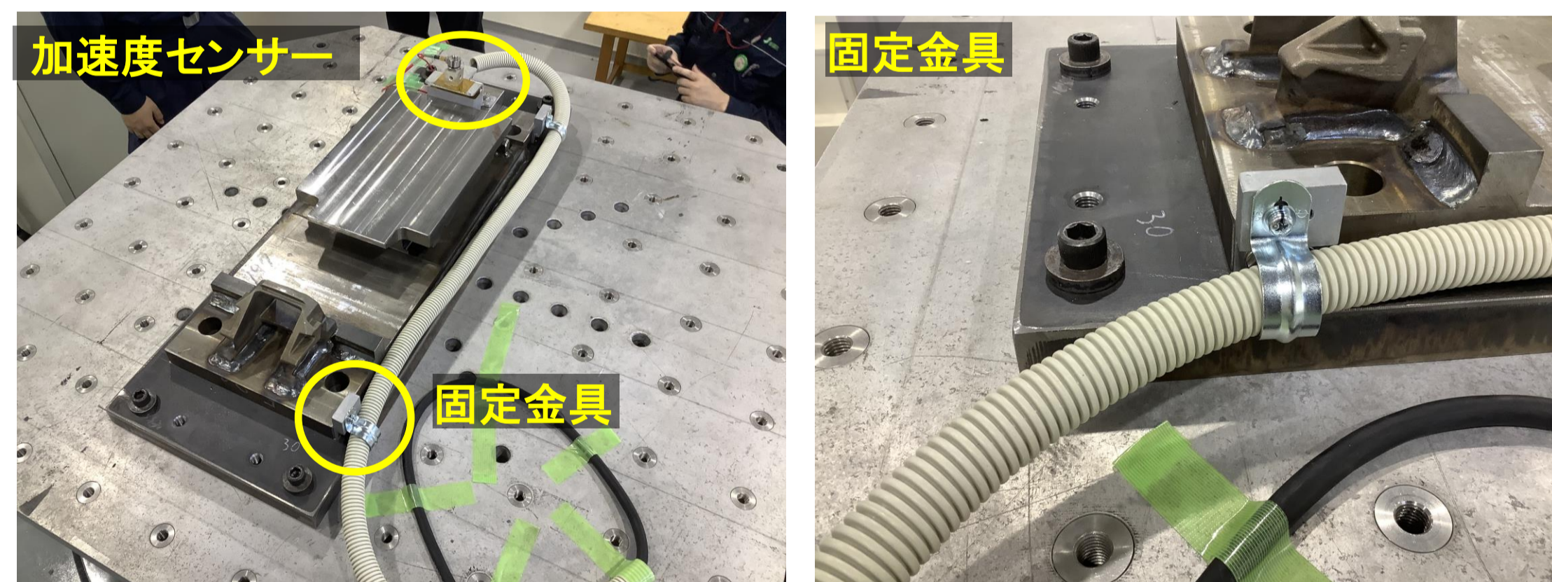
振動試験(電気融雪器ケーブル固定金具)
