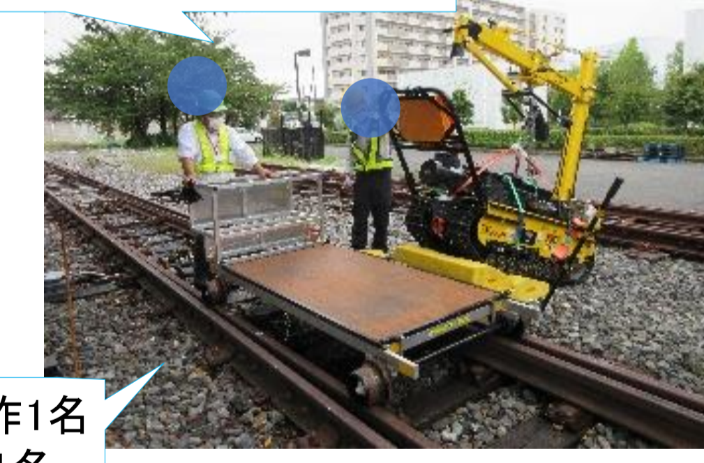
専用治具と専用トロでオンレール化が可能
