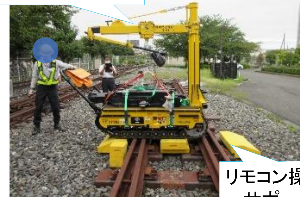
軽量の専用治具でレール横断が可能
