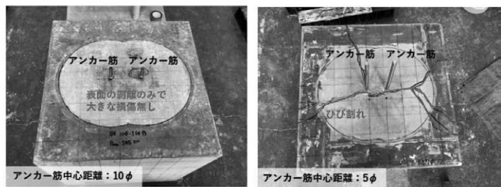
a) アンカー筋の降伏
