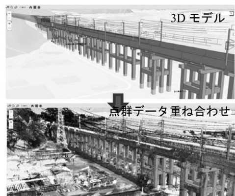
図3 ベースマップ上の3Dモデル・点群データ表示状況
