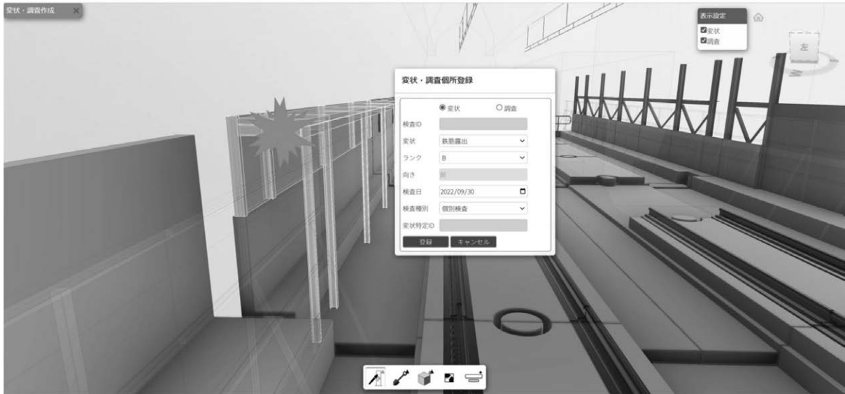
図5 3Dモデルソフトウェア上での調査結果の入力画面例
