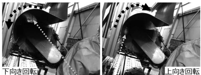
図4 構体5(曲率半径:小)洗浄時の様子
