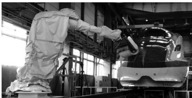
図6 E7系先頭カバー現車洗浄試験
