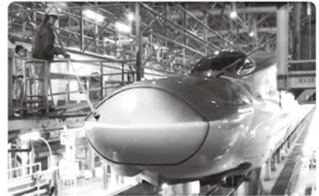
図1 手作業による新幹線先頭部洗浄
