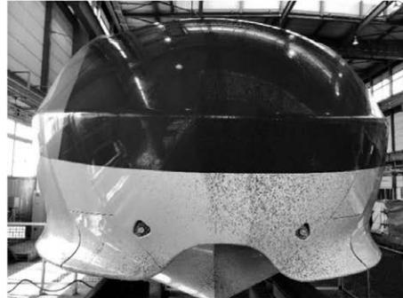
図8 E7系先頭カバー洗淨試験結果（一部工程省略）
