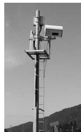
写真10 3次元レーザレーダ方式の障害物検知装置
