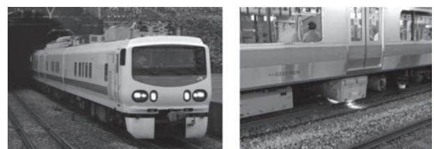
図3 East-iと営業列車での軌道変位測定装置
