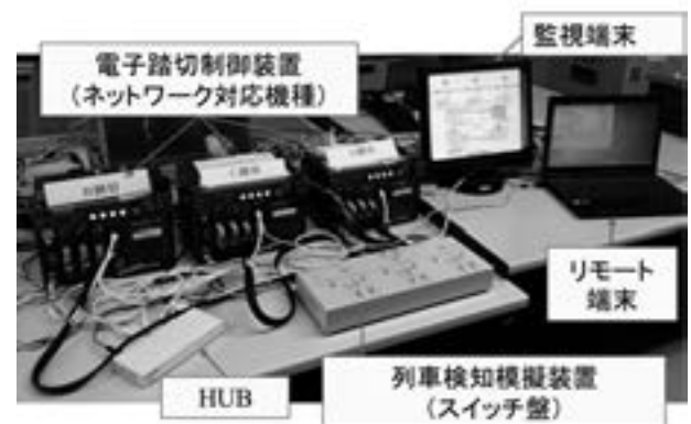
図12 機能確認試験の試験風景
