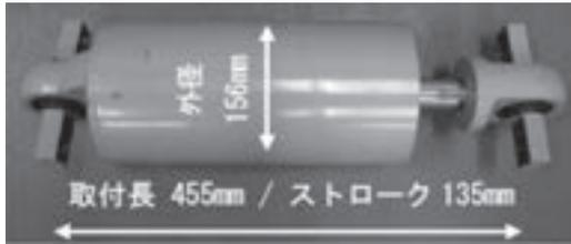
図8 地震対策左右動ダンパーの外観
