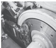
図2 基礎ブレーキ装置
